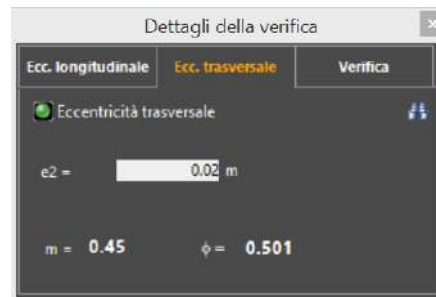
Figura 586. Dettagli verifica tensionale: Eccentricità trasversale
