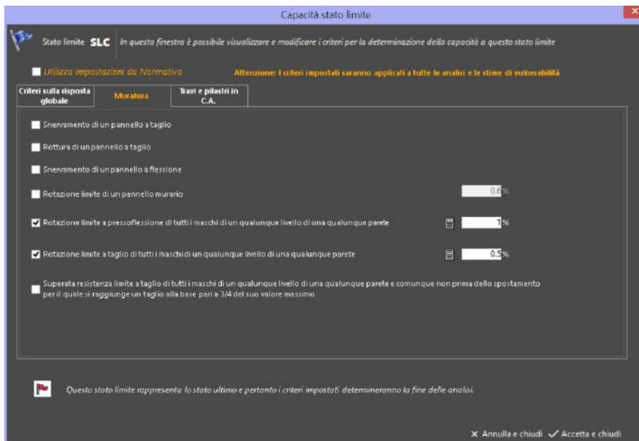
Figura 75. Finestra per la modifica dei criteri di capacità specifici per la muratura (pannelli murari e maschi murari), associata ad uno stato limite.
