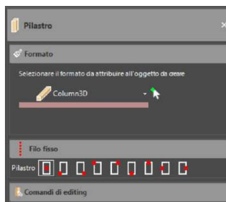
Figura 350. Pannello edit-object per l'immissione di pilastri
