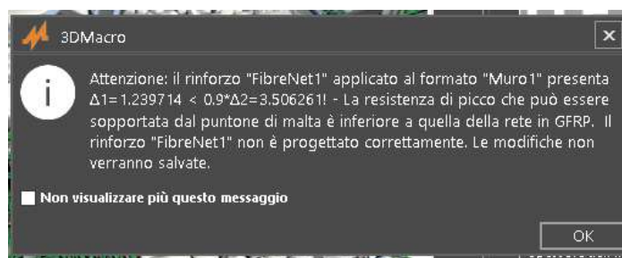
Figura 187. 3DMacro Warning – controllo di bilanciamento della differenza tra \Delta 1 e \Delta 2 , che deve rientrare in una tolleranza del 10%
