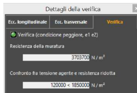
Figura 587. Dettagli verifica tensionale: Esito verifica
