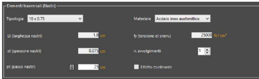
Figura 160. Definizione delle caratteristiche dei Nastri trasversali
