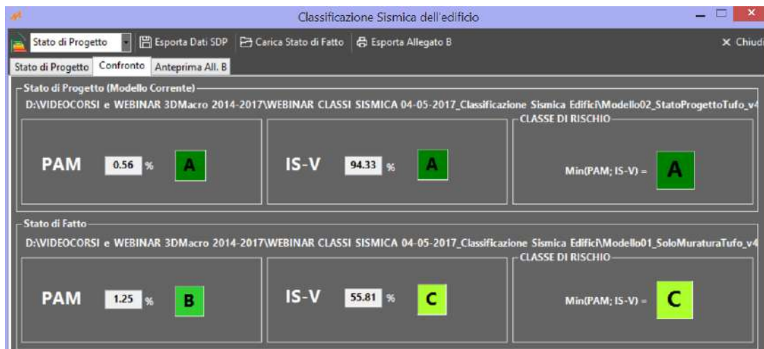
Figura 630. Confronto Classe di Rischio Stato di Progetto – Stato di Fatto
