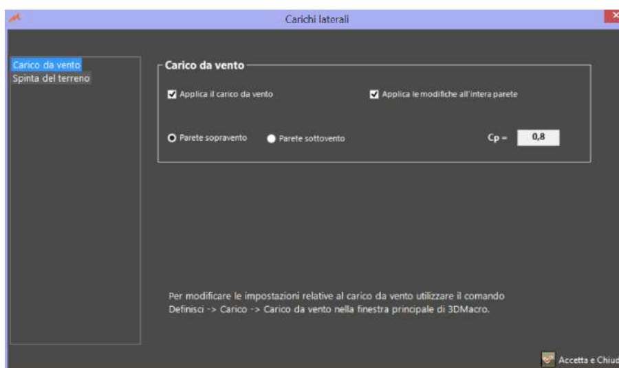
Figura 381 Finestra per la gestione dei carichi di area laterali sul pannello – Carico da vento
