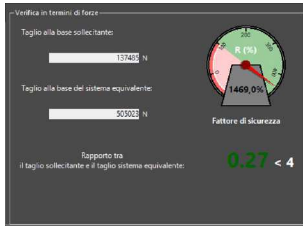
Figura 560. verifica di resistenza minima del sistema equivalente.
