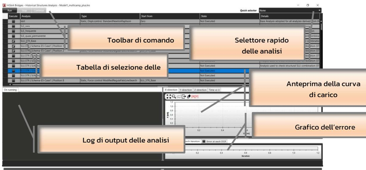
Figura 7.56 – Schermata di selezione delle analisi da eseguire
