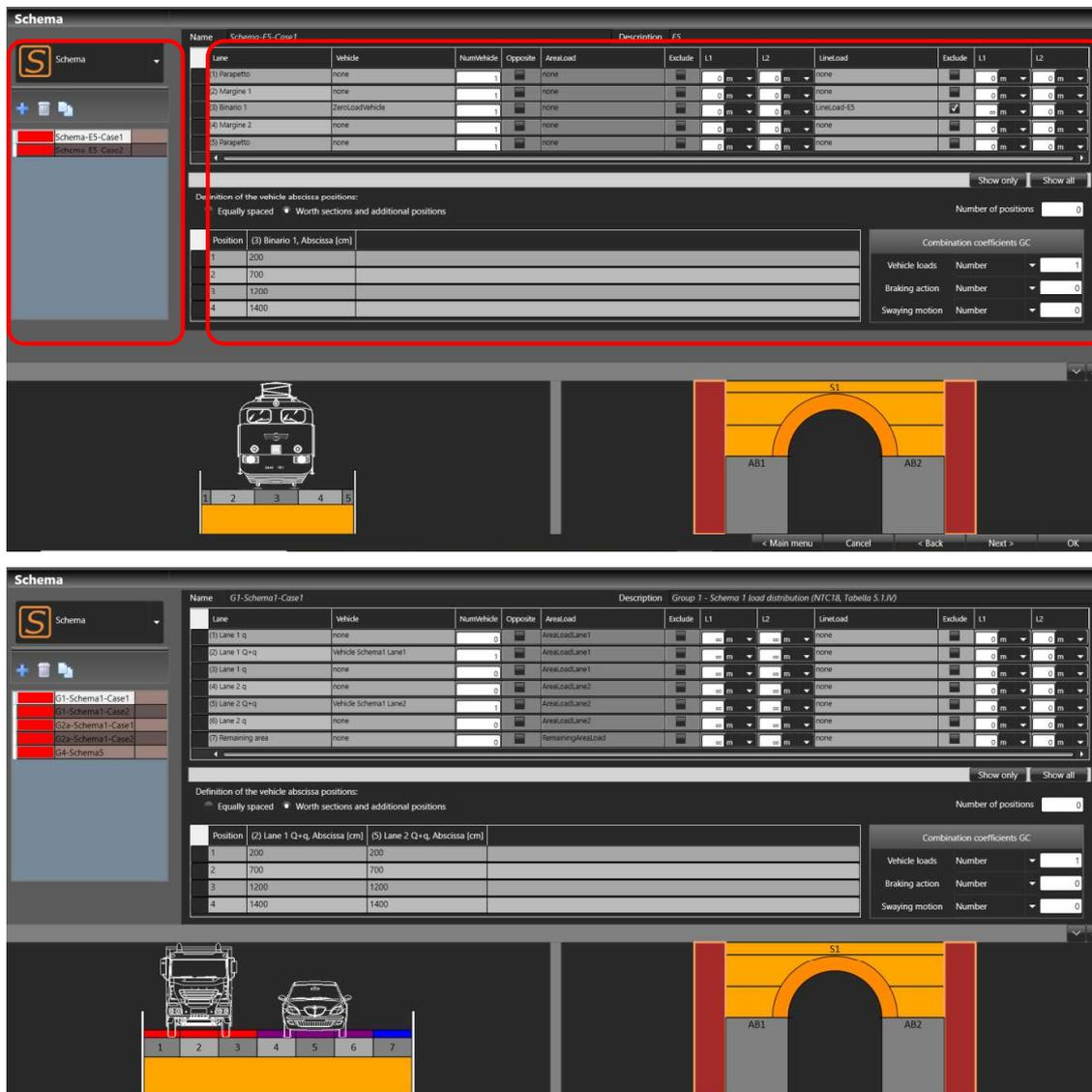
Figura 5.61 – Definizione degli Schemi di Carico per ponte ferroviario e stradale
