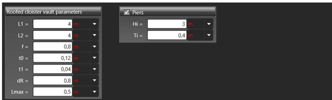
Figura 4.13 - Input parametrico delle caratteristiche geometriche di una volta a specchio.
