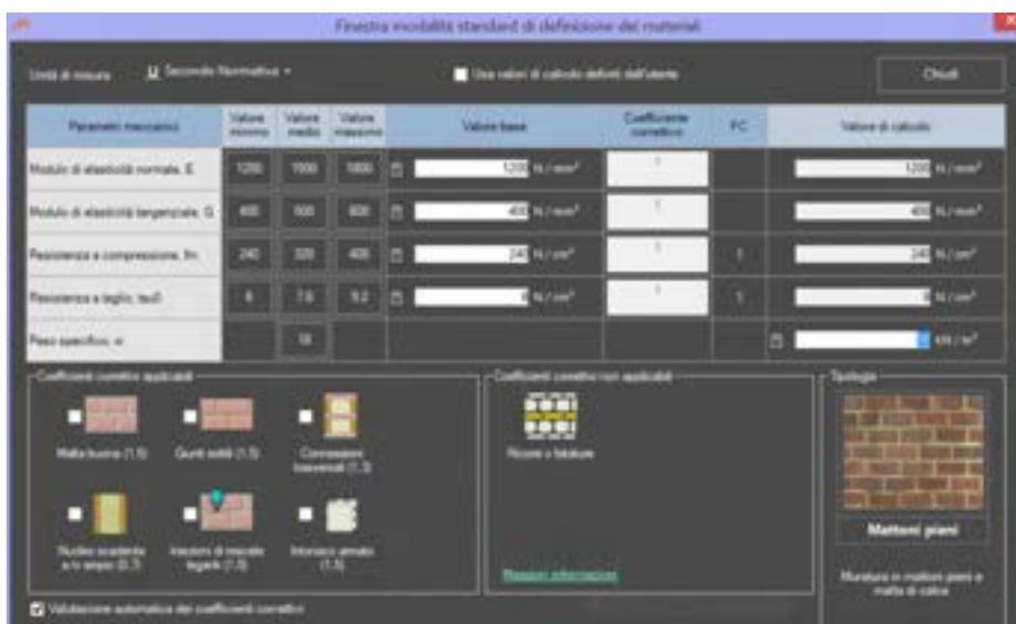
Figura 97. Finestra per la modifica delle caratteristiche meccaniche in modalità standard.
