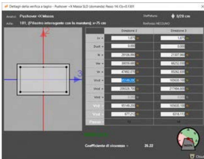
Figura 600. Dettagli della verifica a taglio per la sezione e l'asta selezionata (NTC2018).
