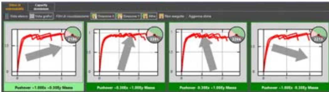
Figura 511. Visualizzazione dei grafici, con sintesi dei risultati della stima di vulnerabilità e verifica. Indicazione della direzione.
