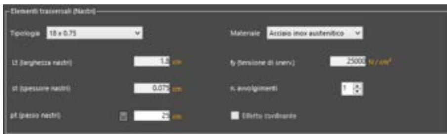
Figura 160. Definizione delle caratteristiche dei Nastri trasversali
