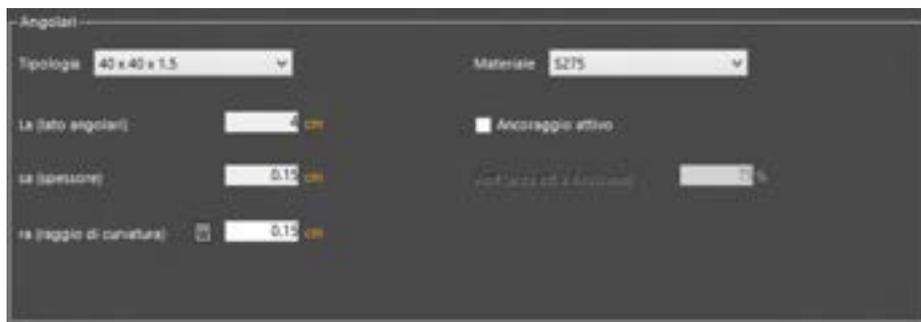
Figura 162. Definizione delle caratteristiche degli Angolari nel caso di rinforzo con calastrellature
