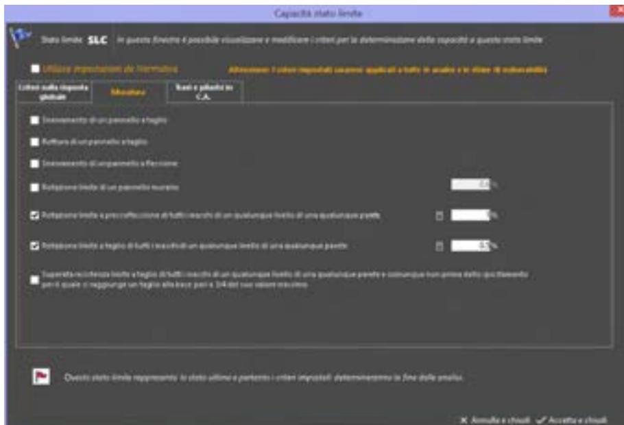
Figura 75. Finestra per la modifica dei criteri di capacità specifici per la muratura (pannelli murari e maschi murari), associata ad uno stato limite.
