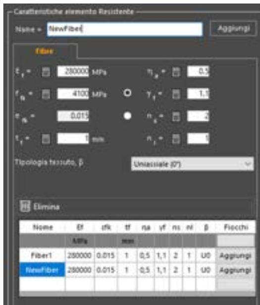
Figura 617. Definizione delle caratteristiche del rinforzo del nodo. Creazione del template.
