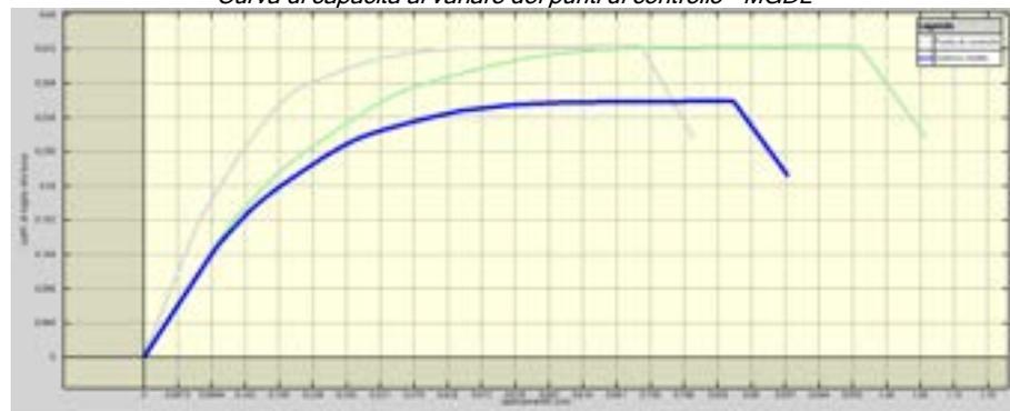
Curva di capacità del sistema ridotto - 1GDL
