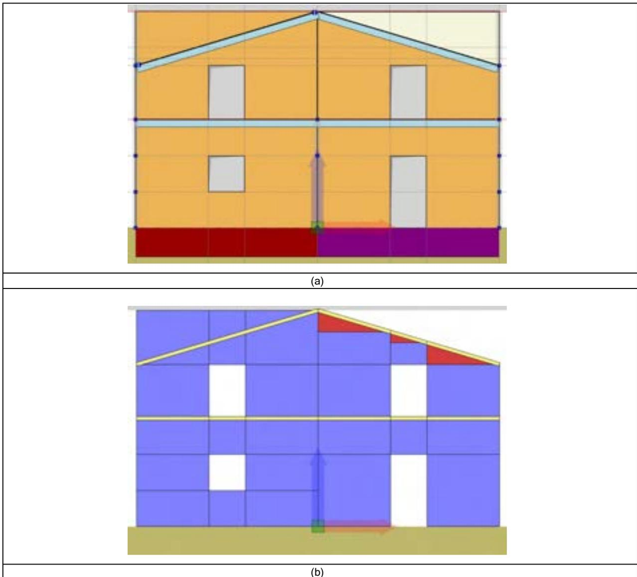
Figura 502. Generazione della mesh. Visualizzazione del modello geometrico (a) e del modello computazionale (b)
