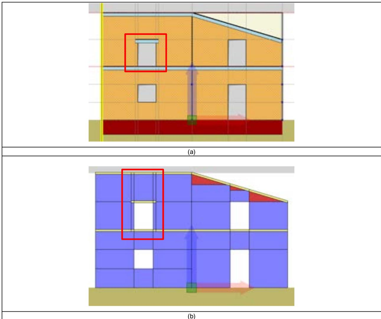
Figura 504. Crea architrave come asta (elemento frame). Visualizzazione del modello geometrico (a) e computazionale (b). La mesh dei pannelli adiacenti all'elemento "frame" (asta) viene condizionata dalla mesh dell'asta (vedi fig. b).
