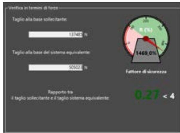
Figura 566. verifica di resistenza minima del sistema equivalente.
