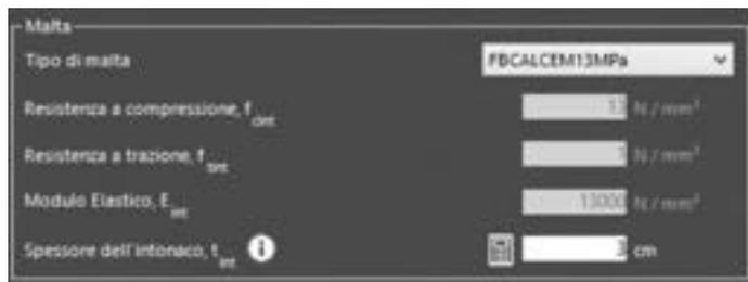
Figura 180. Caratteristiche Malta da Intonaco
